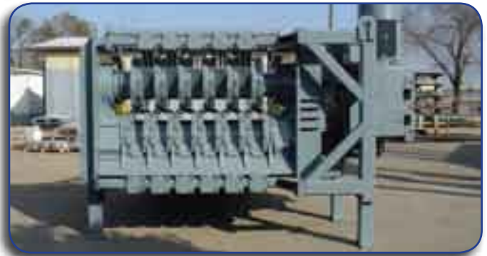
Figura 6-3. Trituradora de llantas con cuchillas espaciadas 6 pulgadas. Foto cortesía de Barclay Roto-Shred Inc, Stockton, California
