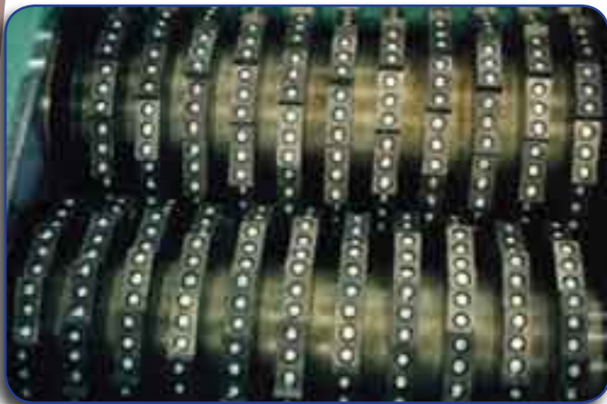
Trituradora con cuchilla desmontable. Foto cortesía de Columbus McKinnon Corporation, Sarasota, Florida
