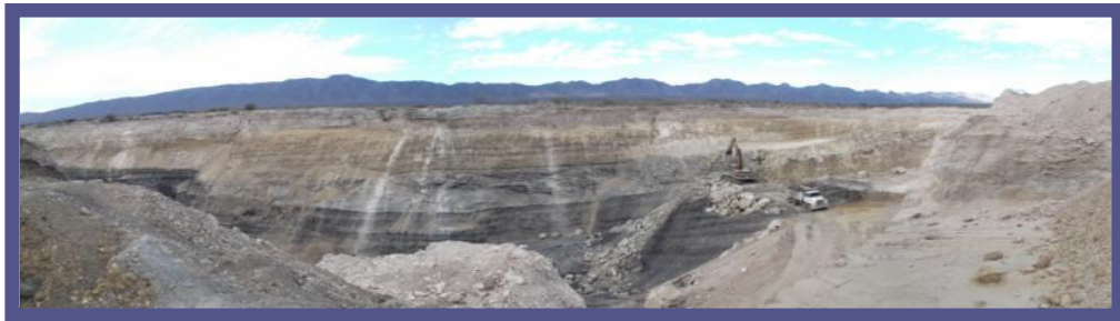
El carbón (capa oscura) es explotado después de remover el suelo superficial (capa de color claro)
