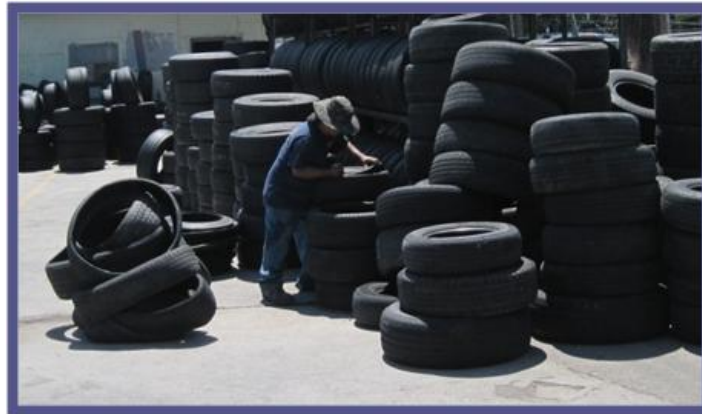
Imagen 9.3. Trabajador removiendo los costados de las llantas de desecho
