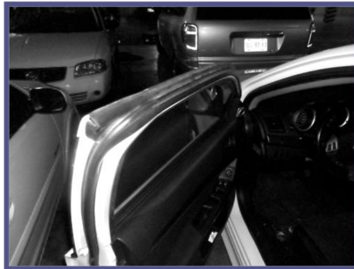
Imagen 8.17. Sello impermeable de un vehículo hecho con hule extruido.
