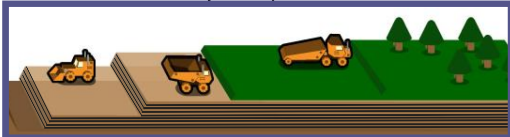
Figura 9.4. Rehabilitación de minas incluyendo capas de llantas de desecho cortadas
