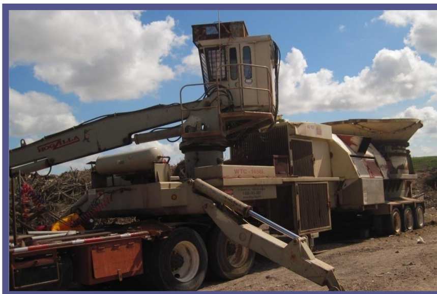
Imagen 4.6. Equipo Hogzilla® usado para la trituración de llantas de desecho
