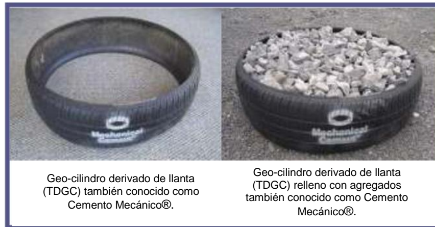
Imagen 8.6. Imágenes de Cemento Mecánico® y Concreto Mecánico.
