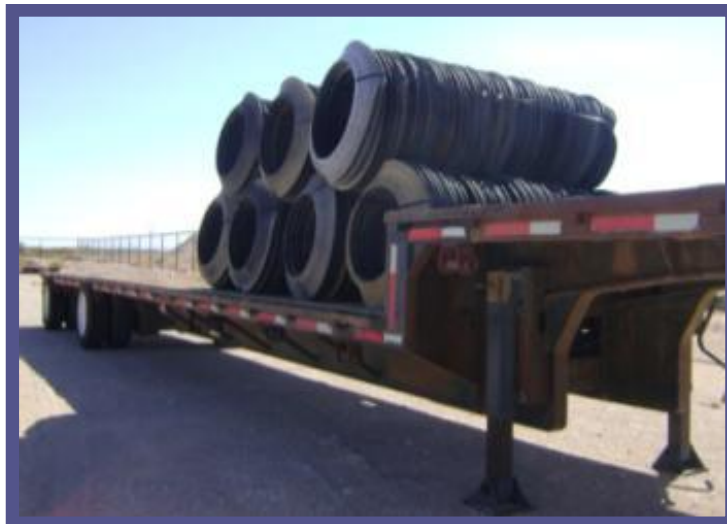
Imagen 8.1. Costados de llantas de pasajero cortadas en el hombro 2 listas para ser transportadas a un sitio de procesamiento en El Paso, Texas, USA.
